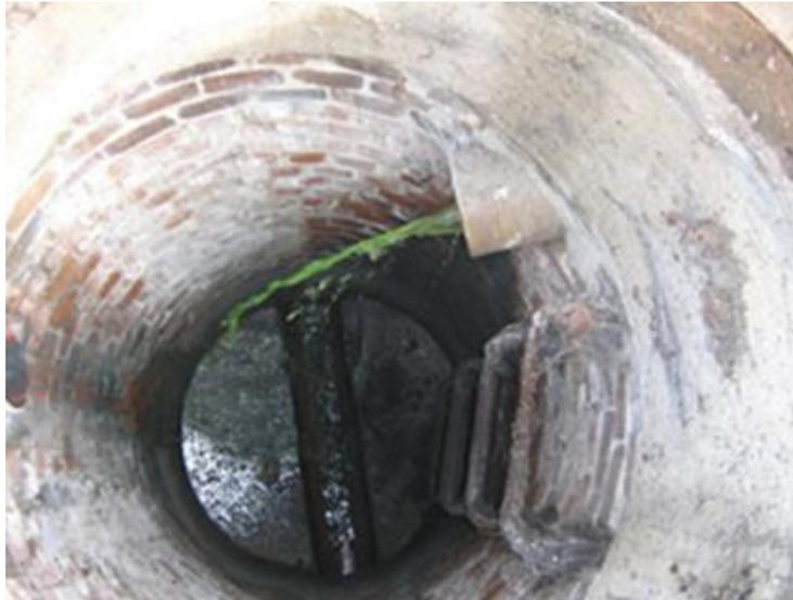
Abbildung III-1: Identifizierung von Falschanschlüssen mit Lebensmittelfarbe im Regenwasserkanal
