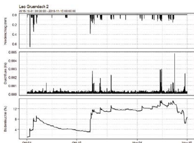
Abb. 3: Übersicht der Messgrößen Niederschlag, Bodenfeuchte und Durchfluss für Gründach 2 mit 6 cm Substrat am Leonardo-Campus Münster für den Zeitraum 01.10.2016 bis 15.11.2016
