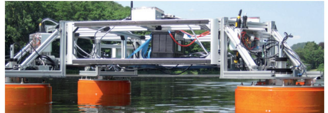
Das autonom operierende Messfahrzeug „Hydrocrawler“ tastet mit unterschiedlichen Sensoren die Sedimentoberfläche des Bodensees ab
