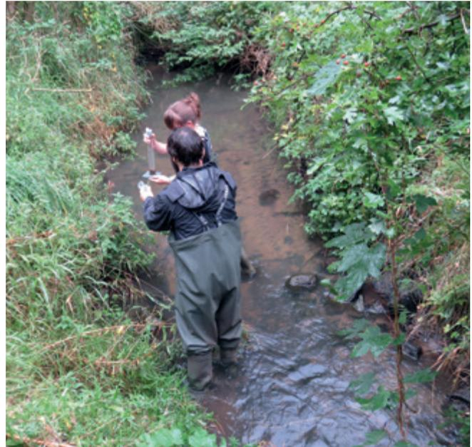
Probenahme in der Zarnow im Warnow-Einzugsgebiet zur späteren Analyse der Phosphorfractionen
