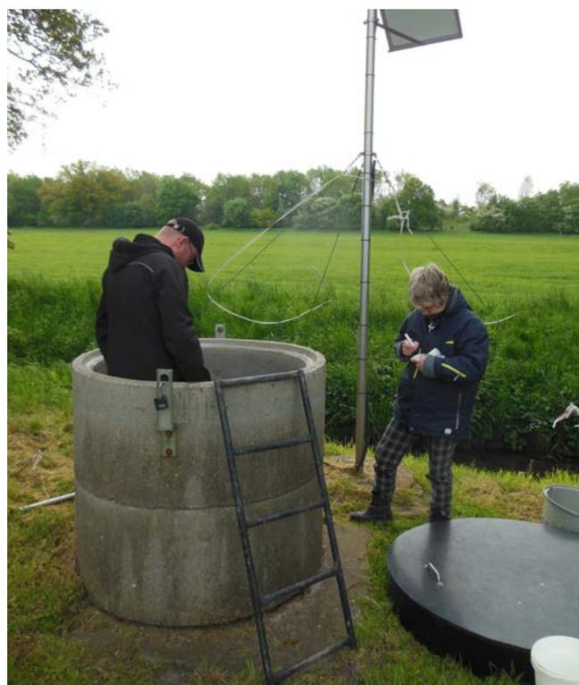
Untersuchung der Nährstoffeinträge durch Drän- und Bachwasser am Standort Dummerstorf. Entnahme der Proben vom Autosampler, Foto: S. Jahn, IOW
