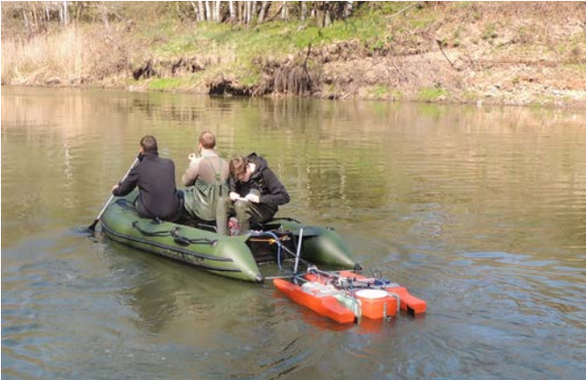
Messboote im Einsatz: Schleppverband auf Freiberger Mulde, C. Koch, TU Dresden
