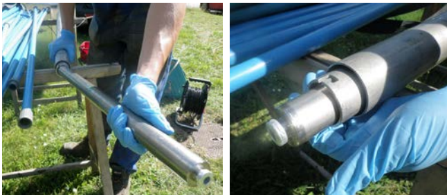
Das neu entwickelte druckhaltende Probenahmesystem (BGD ECOSAX GmbH). a) Entnahme eines Probengefäßes aus dem druckhaltenden Probenahmesystem. b) Detailaufnahme des druckhaltenden Probengefäßes, Foto: F. Kurzius, BGD GmbH
