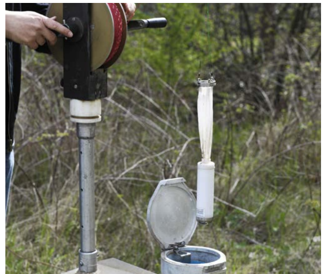
Zur Erfassung der Grundwassertiere wird ein sogenannter Netzsammler mithilfe einer Seilwinde in die Grundwassermessstelle bis auf den Messstellengrund abgeseilt, Foto: IGÖ GmbH
