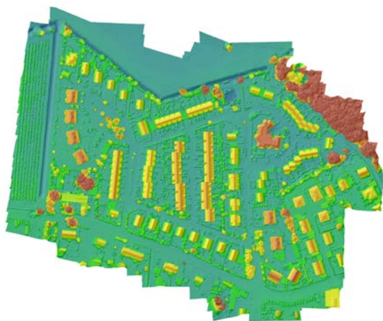
Erstelltes Oberflächenmodell (Gitterweite 0,02 m) auf Grundlage einer UAV-Befliegung, Grafik: Universität Rostock
