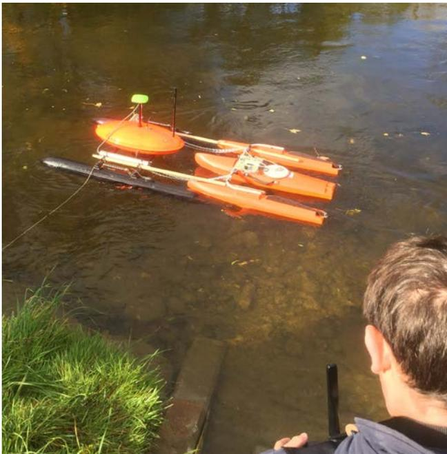
Strömungsmessung mit dem ADCP-Gerät, Foto: R. Engels, FiW
