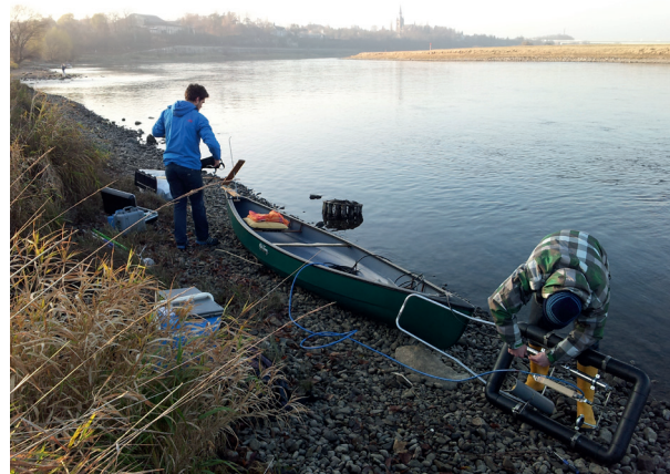
Das Messboot ist so klein, dass man mit ihm auch kleine Fließgewässer in ihrem Längsverlauf untersuchen kann.
