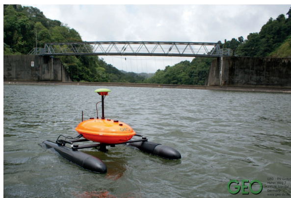
Das ferngesteuerte Mini-Katamaran „Sonobot“ im Einsatz: Auf seiner Fahrt misst er alle relevanten Daten des Flusses von Temperatur bis Fließgeschwindigkeit.
