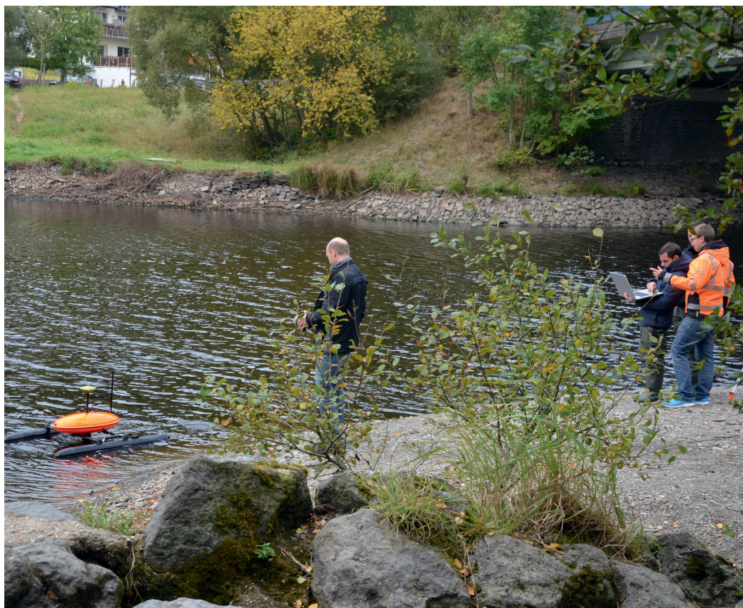
Bild 2 Die Partner des ReWaM-Projekts RiverView haben ein Trägerboot entwickelt, das ferngesteuert kleine und mittlere Flussläufe befahren kann.
