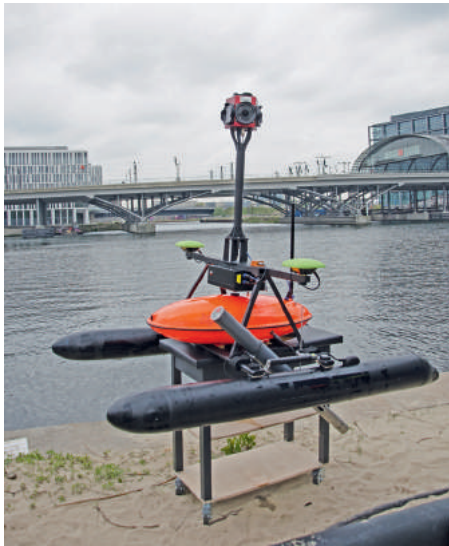
Bild 2 RiverBoat mit Kameragestell und Zwei-Antennen- GNSS Quelle: FiW e.V.
