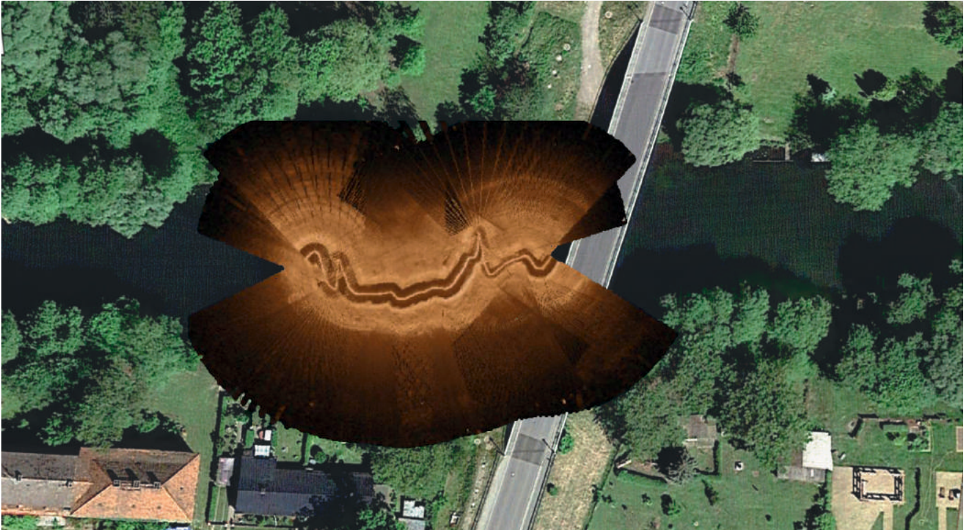
Bild 8 Georeferenzierte Sidescan-Aufnahme an einer Spreerbrücke
