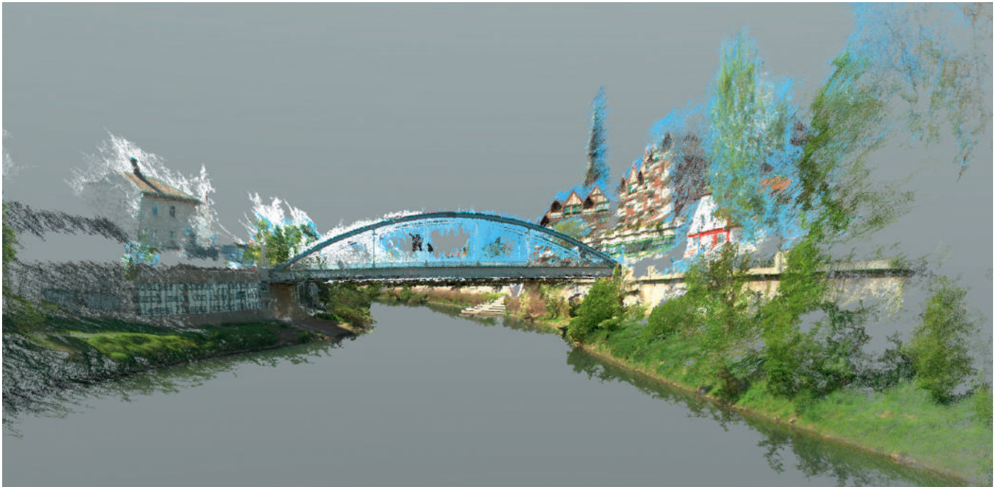
Bild 4 Beispiel für eine bildbasierte Punktwolke von RiverView
