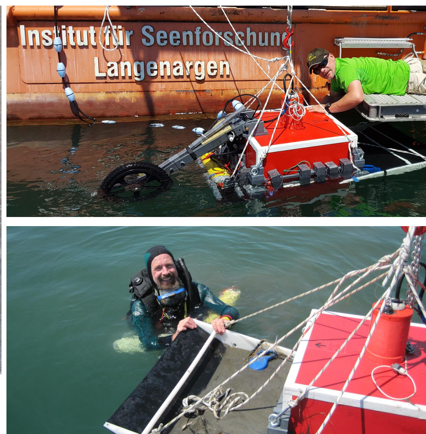
Der Prototyp des an der TU Darmstadt entwickelten Unterwasser-Georadar
