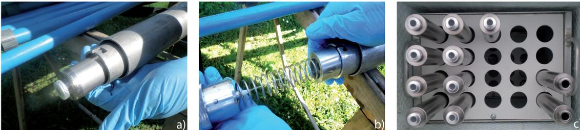
**Das weiterentwickelte sterilisierbare Probennahmesystem.** a) Entnahme eines Probengefäßes aus dem Probennahmesystem b) Nahaufnahme des Inneren des Probennahmesystems c) Kühlbox für den Transport der Probengefäße
