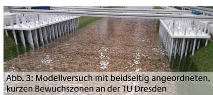
Abb. 3: Modellversuch mit beidseitig angeordneten, kurzen Bewuchszonen an der TU Dresden
