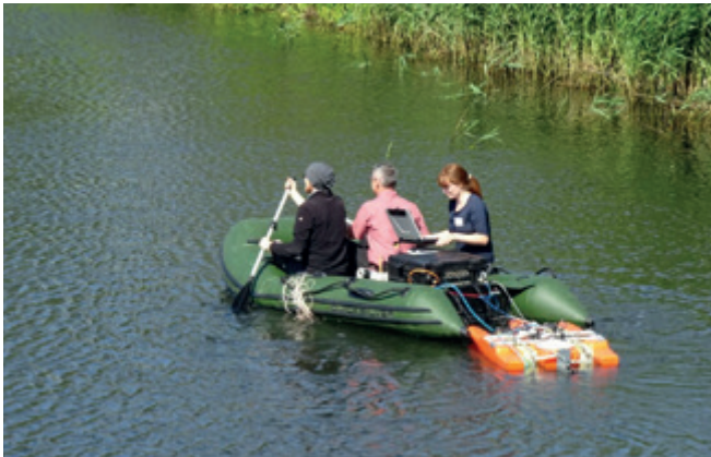
Abb. 2: Messkonzept für flache Gewässer (Schleppverband mit getauchter Sensorik), Foto: Christian Koch, TU Dresden
