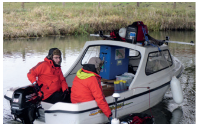
Abb. 1: Messkonzept für schiffbare Gewässer (Wasser wird durch Messsystem an Bord gepumpt). Foto: Wolfgang Klehr, Uni Rostock
