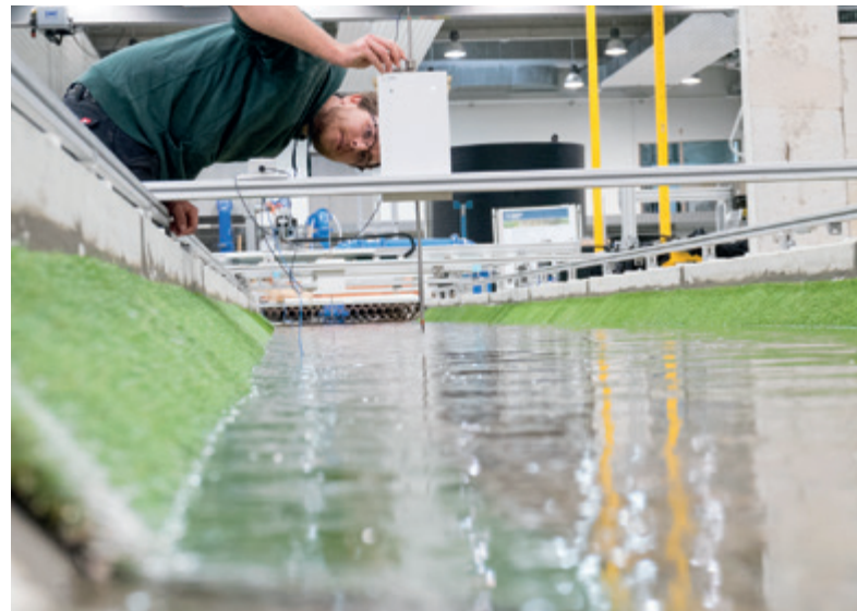
Abb. 2: Messung des Wasserstands am Modellversuch im Wasserbaulabor der TU Dresden im Rahmen einer Diplomarbeit. Der Modellversuch bildet den Mortelbach im Maßstab 1:4 ab. Foto: André Terpe, TU Dresden
