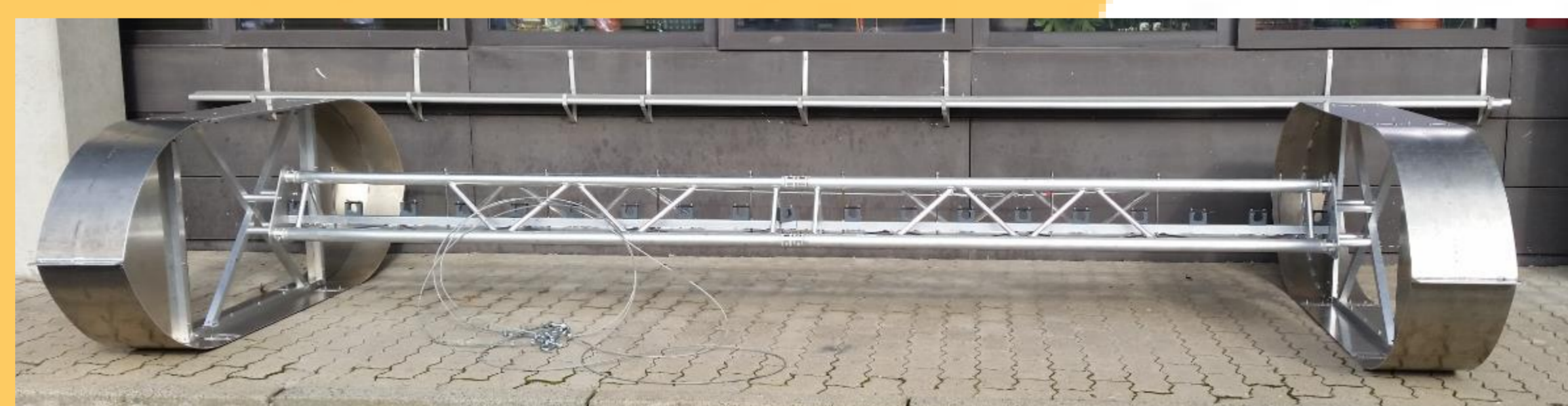
Ein neu entwickeltes Messgerät: Mit dem thermalen Kartierer können Temperaturanomalien am Seeboden räumlich und zeitlich hochaufgelöst gemessen werden.
