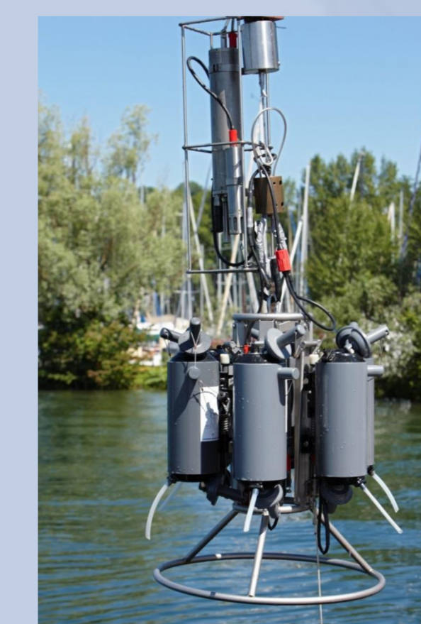
Mit dem Rosettenschöpfer können Wasserproben aus definierten Tiefen genommen werden.
