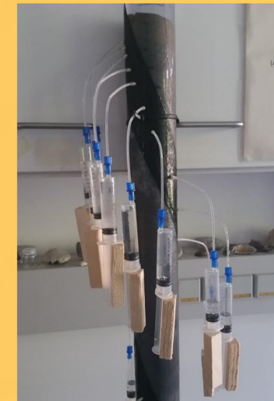
Porenwasserbeprobung mit Rhizonen.
