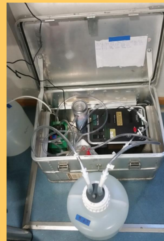
Radonmessung von Wasserproben.
