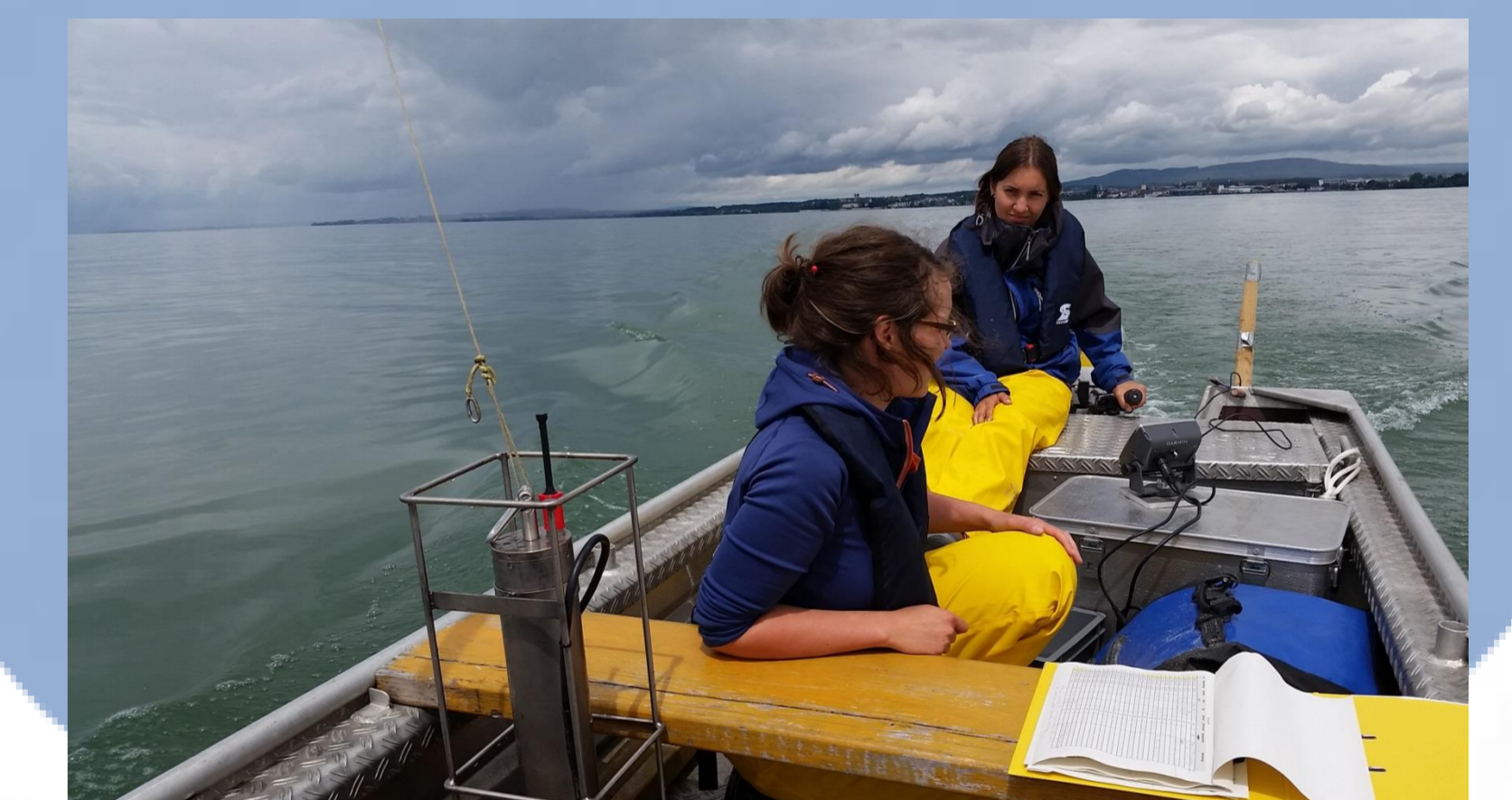
Mit einer Multiparametersonde (z.B. Temperatur, Leitfähigkeit, Sauerstoff) werden entlang eines Rasters monatlich Tiefenprofile aufgezeichnet.
