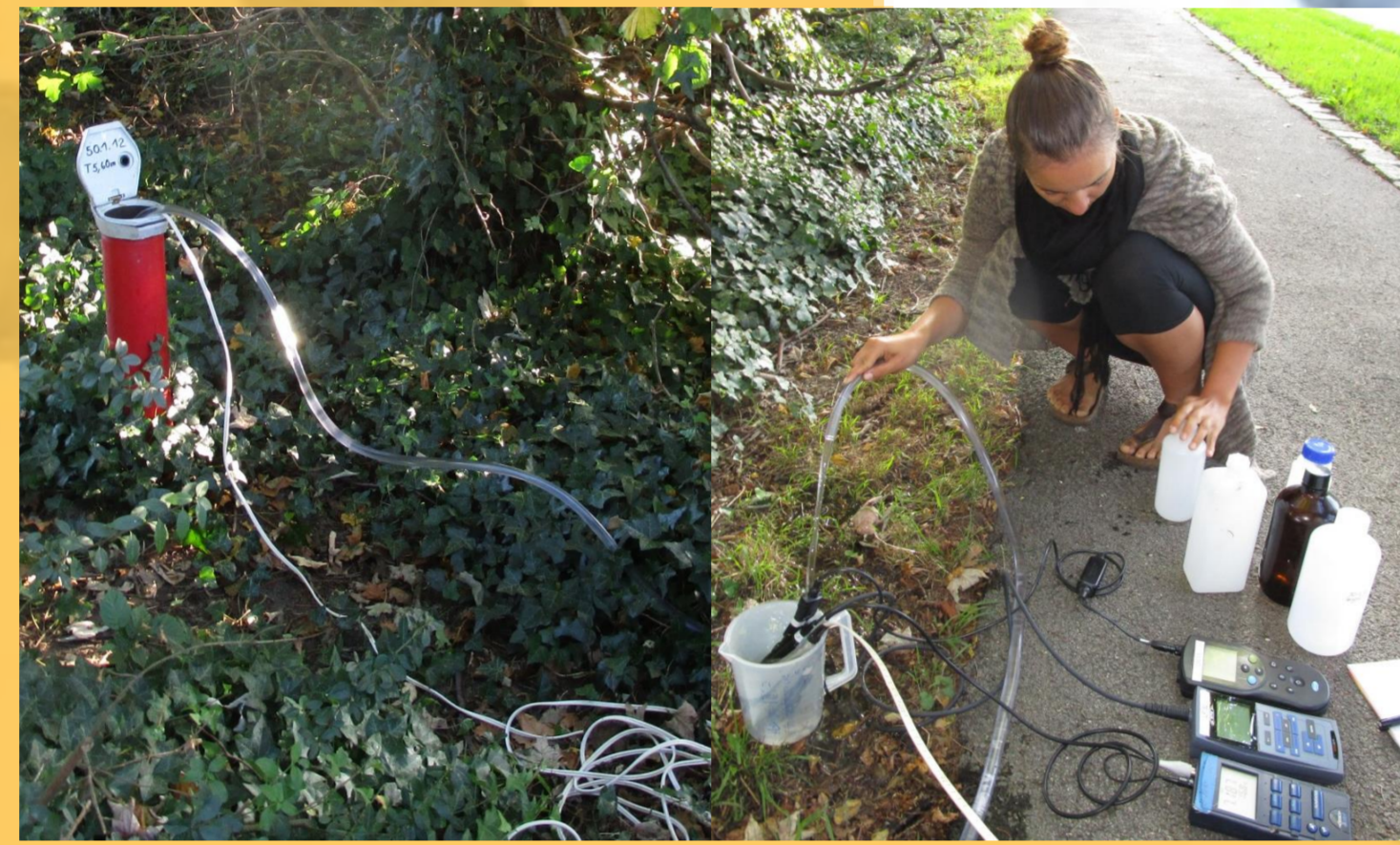
Beprobung der Grundwasserqualität an ausgewählten Grundwassermessstellen.
