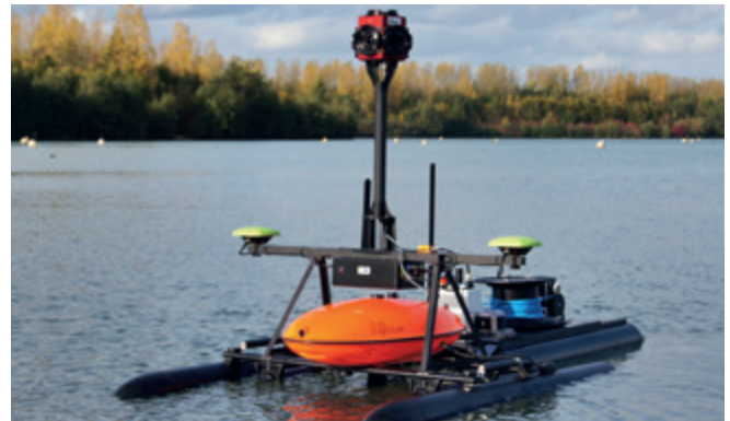
Abb. 1: RiverBoat mit modularem Kameramodul und Trailer. Foto: FiW e.V.
