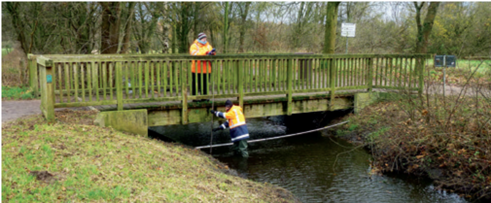
Abb. 2: Durchflussmessungen an der Kollau im Rahmen von Stuck. Foto: LSBG
