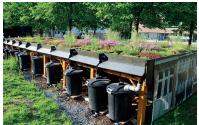
Abb. 1: Gründach-Versuchsanlagen mit Messeinrichtungen in Münster (10 Flächen á 3 m 2 ). Foto: Isabel Scherer, FH Münster
